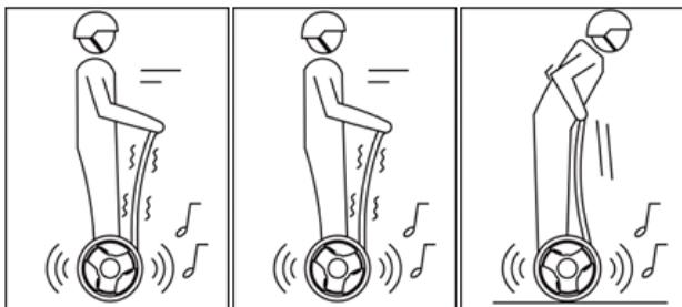
*Спуск на высокой скорости. Подъем по крутому склону или длительная стоянка на нем. Низкий заряд аккумулятора.*
